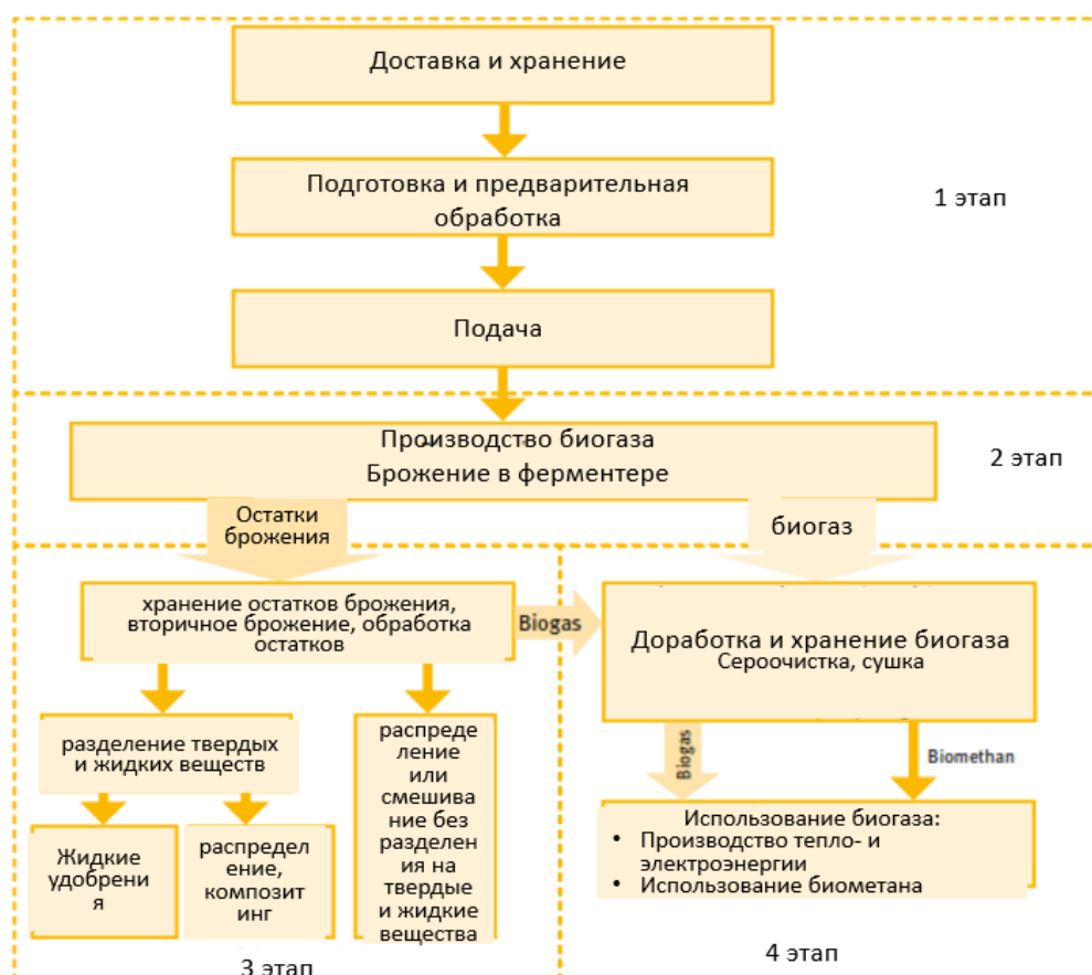
Рисунок 3. Общая последовательность технологических этапов производства биогаза
